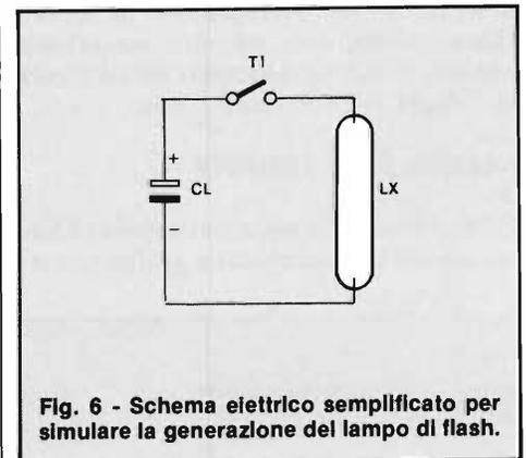
Fig. 6 - Schema elettrico semplificato per simulare la generazione del lampo di flash.
