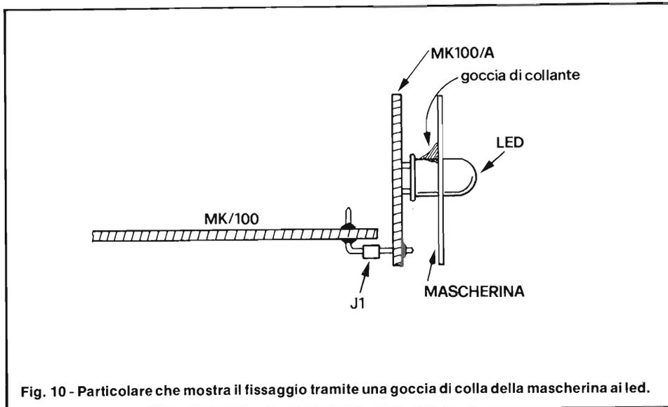
Fig. 10 - Particolare che mostra il fissaggio tramite una goccia di colla della mascherina ai led.
