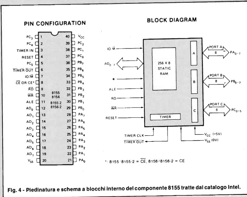
Fig. 4 - Piedinatura e schema a blocchi interno del componente 8155 tratte dal catalogo Intel.
