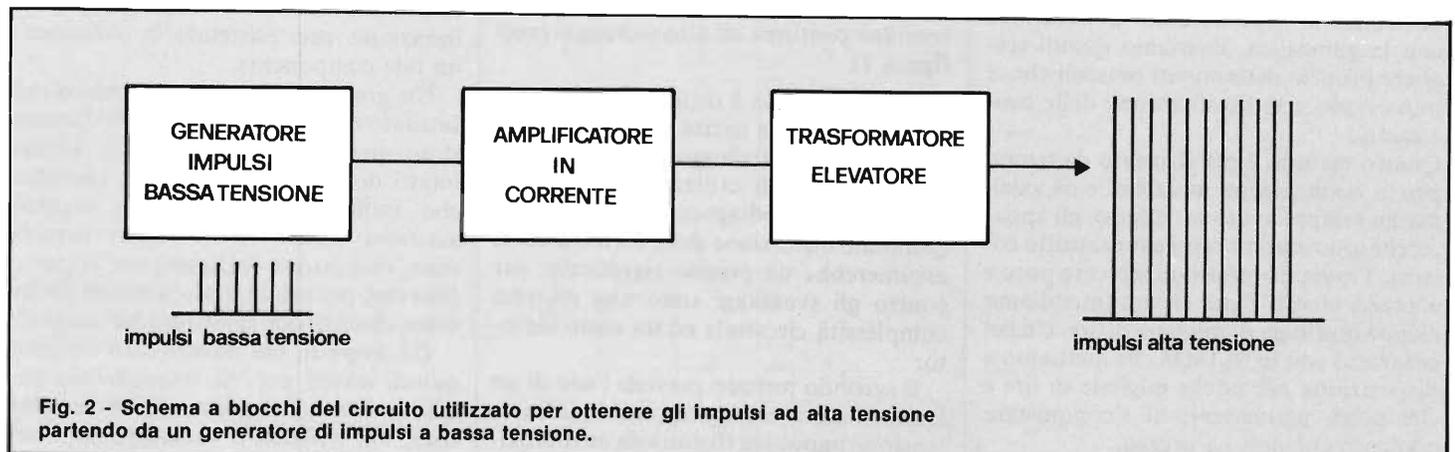
Fig. 2 - Schema a blocchi del circuito utilizzato per ottenere gli impulsi ad alta tensione partendo da un generatore di impulsi a bassa tensione.
