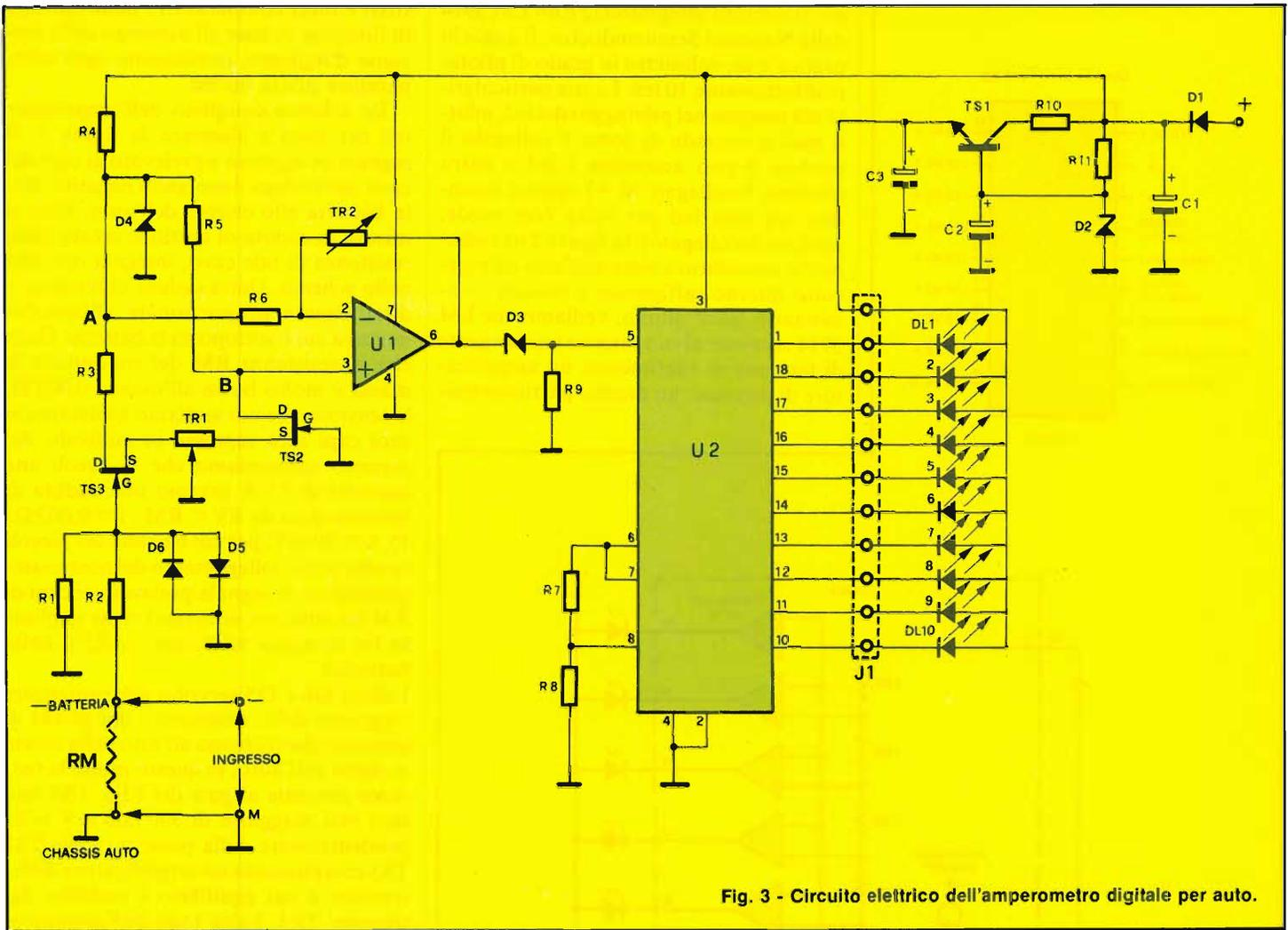
Fig. 3 - Circuito elettrico dell'ampmetro digitale per auto.
