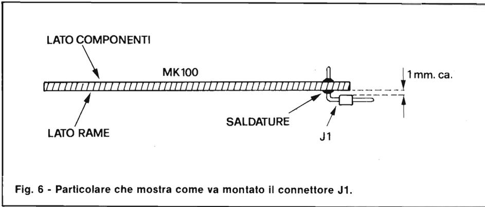
Fig. 6 - Particolare che mostra come va montato il connettore J1.
