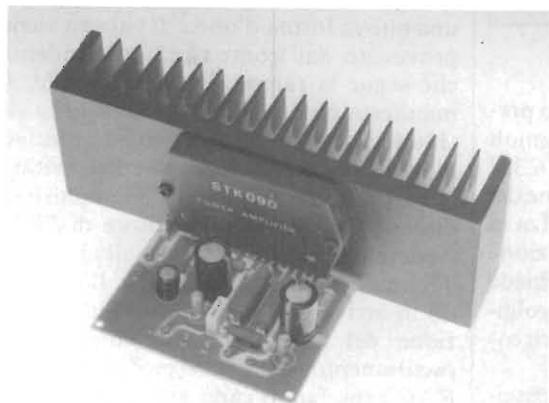
Con l'esclusiva tecnologia di costruzione gli integrati realizzati in Thick-film, unitamente a pochi componenti passivi esterni formano un dispositivo amplificatore di qualità elevata. Garantiscono: alta sensibilità d'ingresso, notevoli potenze d'uscita, frequenze di risposta molto ampie, pur mantenendo i loro valori in distorsione estremamente bassi.
