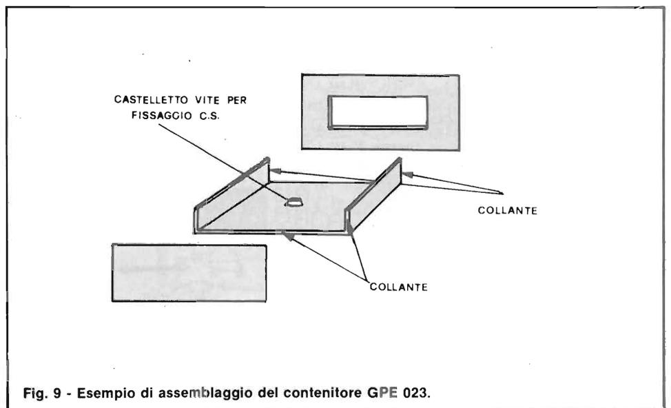
Fig. 9 - Esempio di assemblaggio del contenitore GPE 023.
