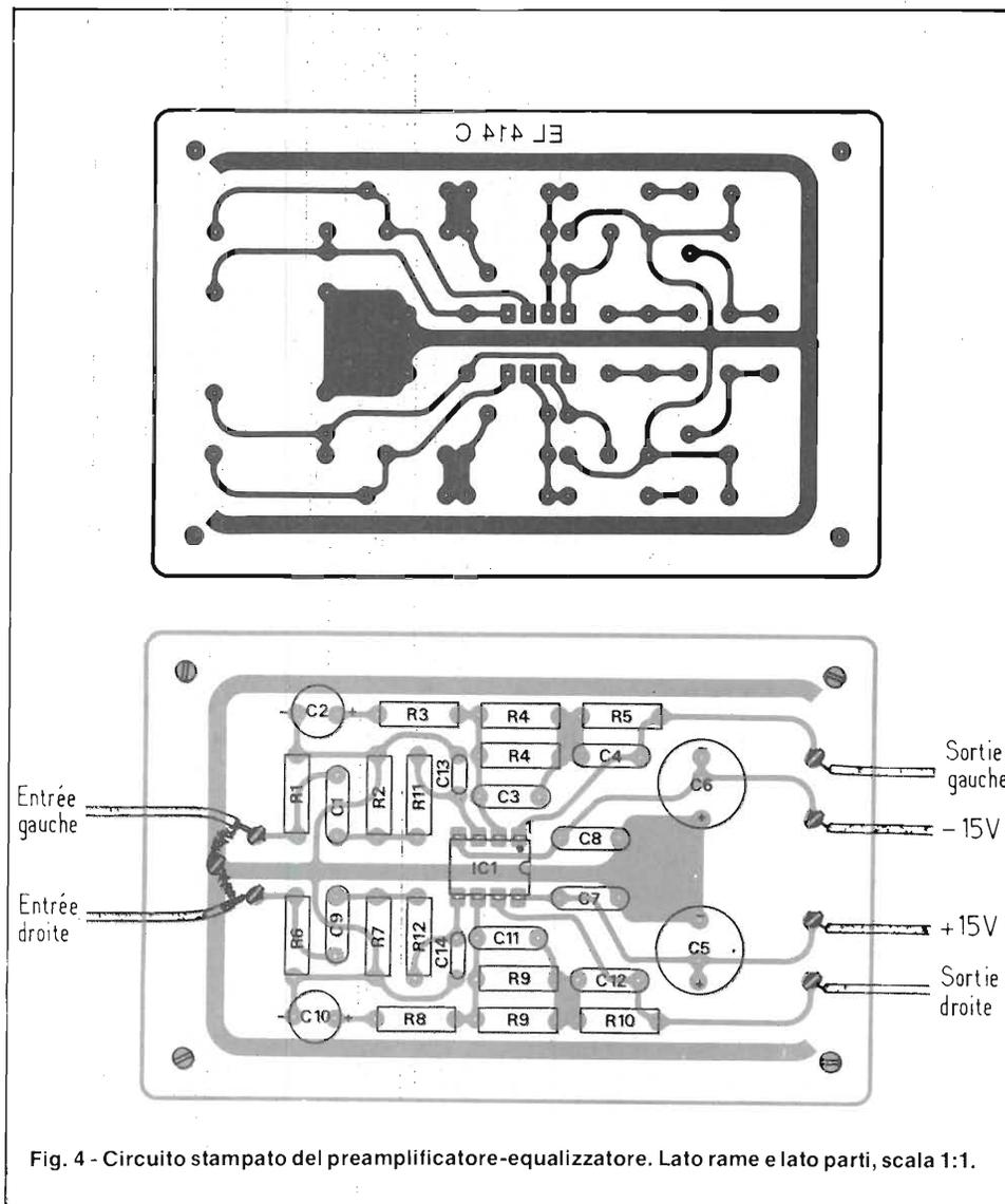
Fig. 4 - Circuito stampato del preamplificatore-equalizzatore. Lato rame e lato parti, scala 1:1.
