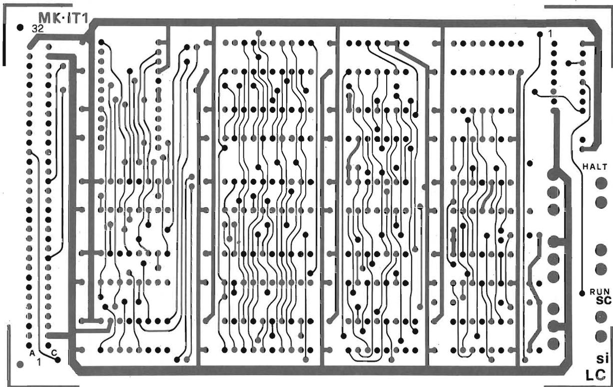
Fig. 10 - Schema di montaggio della scheda MK - IT1.
