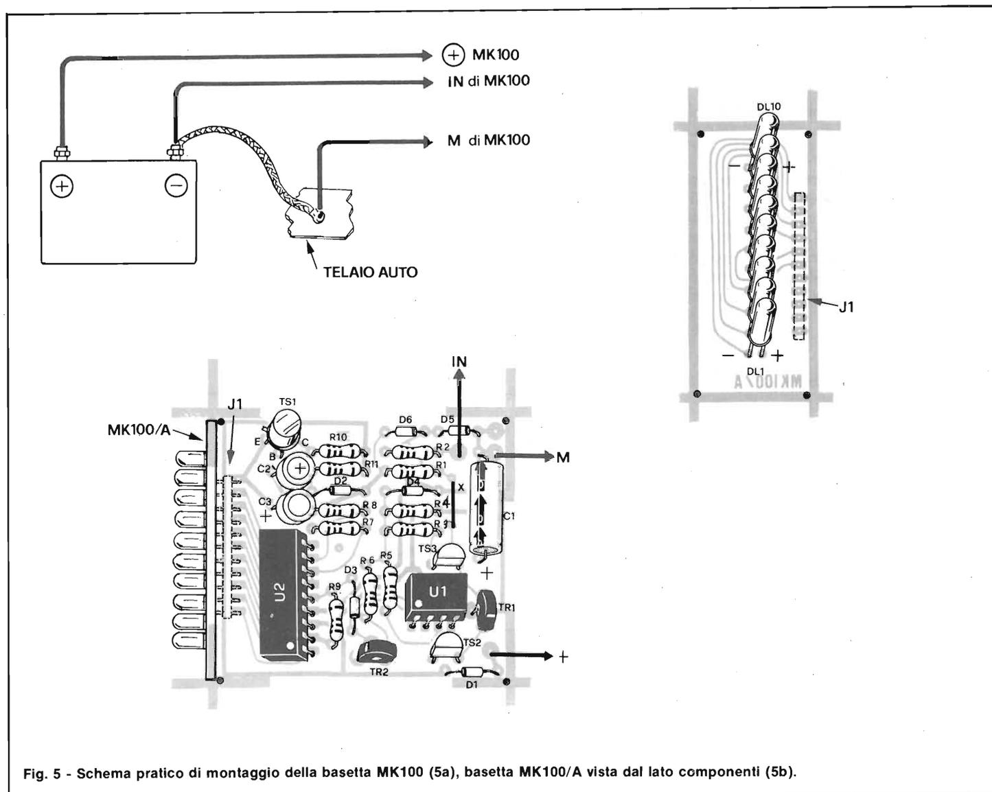
Fig. 5 - Schema pratico di montaggio della bassetta MK100 (5a), bassetta MK100/A vista dal lato componenti (5b).
