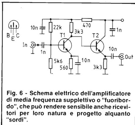
Fig. 6 - Schema elettrico dell'amplificatore di media frequenza suppletivo o "fuoribordo", che può rendere sensibile anche ricevitori per loro natura e progetto alquanto "sordi".
