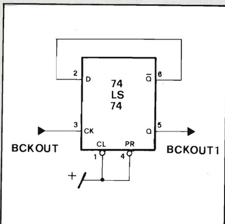
Fig. 6 - Schema del circuito, utilizzando un 74LS74, necessario per introdurre una divisione per due sul clock in uscita dal microprocessore.
