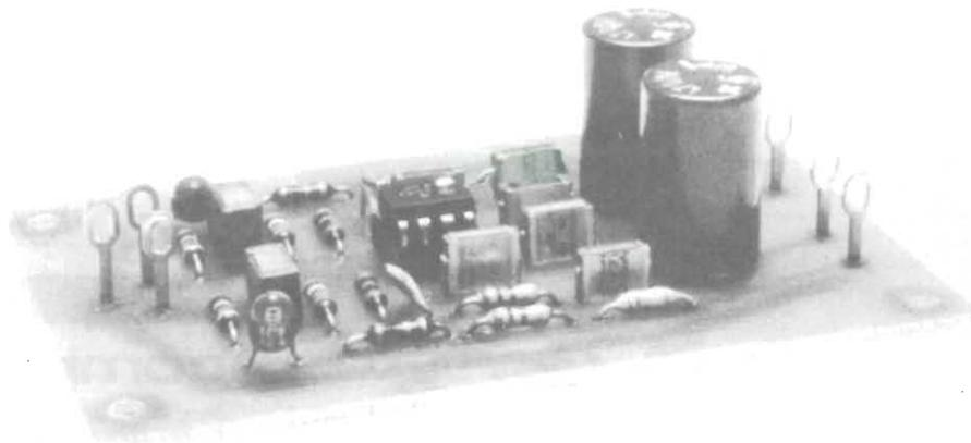
Fig. 5 - Fotografia del prototipo del preamplificatore-equalizzatore.
