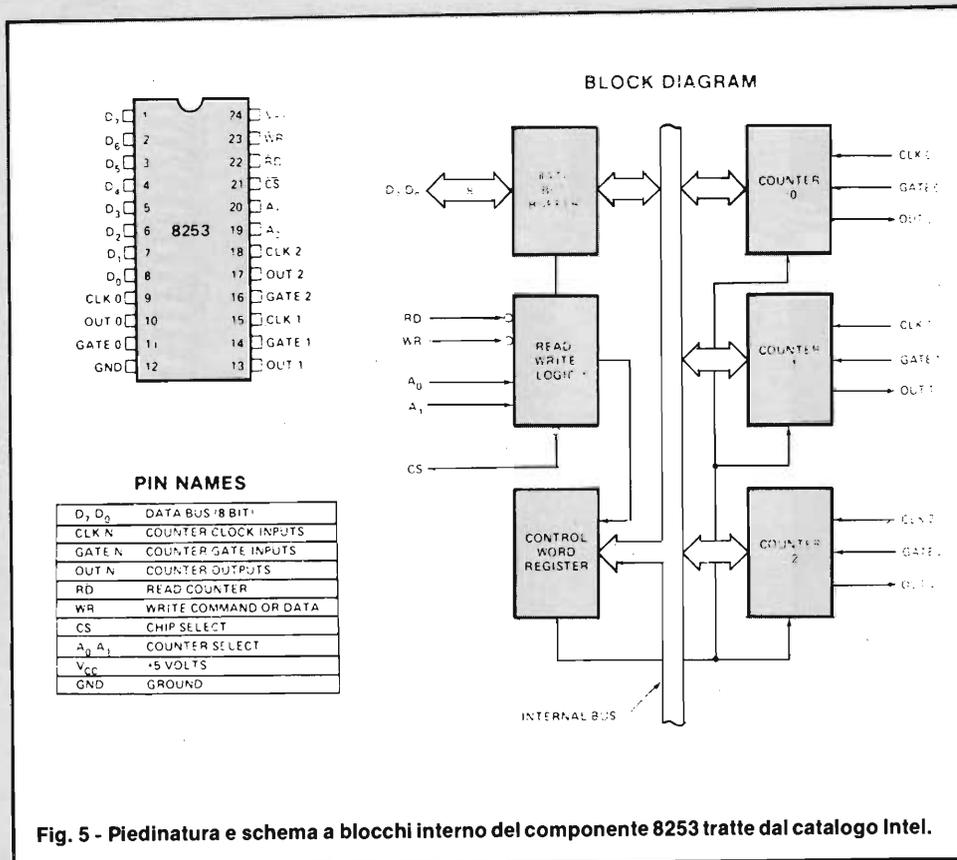
Fig. 5 - Piedinatura e schema a blocchi interno del componente 8253 tratte dal catalogo Intel.
