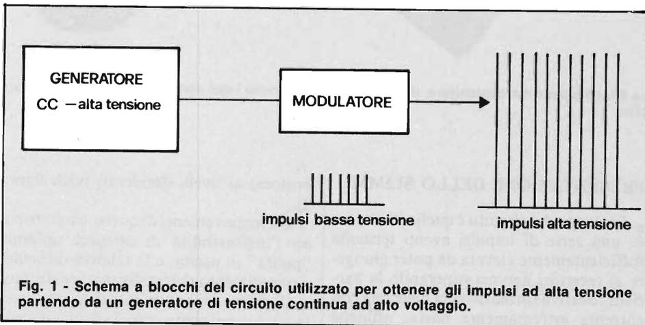
Fig. 1 - Schema a blocchi del circuito utilizzato per ottenere gli impulsi ad alta tensione partendo da un generatore di tensione continua ad alto voltaggio.
