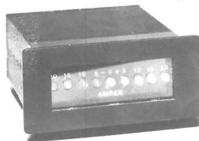
Foto 3 - Lo strumento racchiuso nell'apposito contenitore plastico, le cui ridotte dimensioni permettono una agevole installazione a bordo dell'autovettura.
