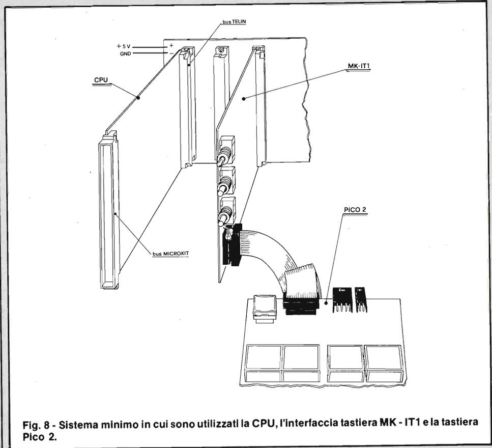
Fig. 8 - Sistema minimo in cui sono utilizzati la CPU, l'interfaccia tastiera MK - IT1 e la tastiera Pico 2.
