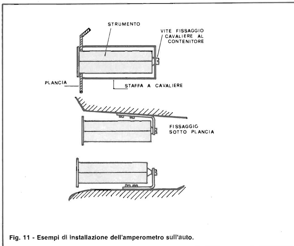
Fig. 11 - Esempi di installazione dell'amperometro sull'auto.
