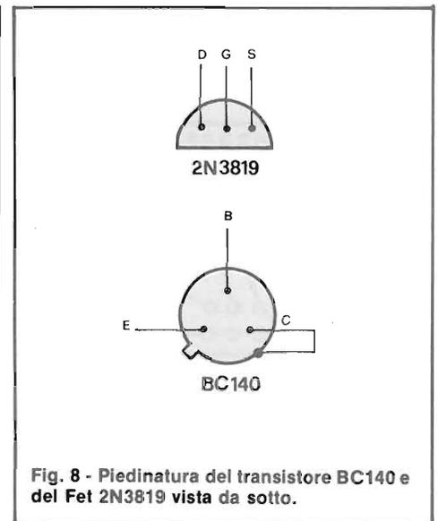
Fig. 8 - Piedinatura del transistor BC140 e del Fet 2N3819 vista da sotto.
