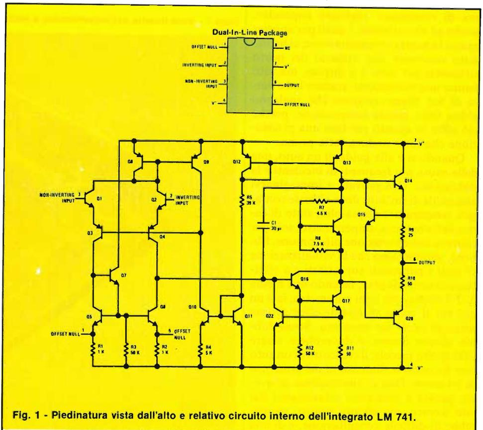
Fig. 1 - Piedinatura vista dall'alto e relativo circuito interno dell'integrato LM 741.
