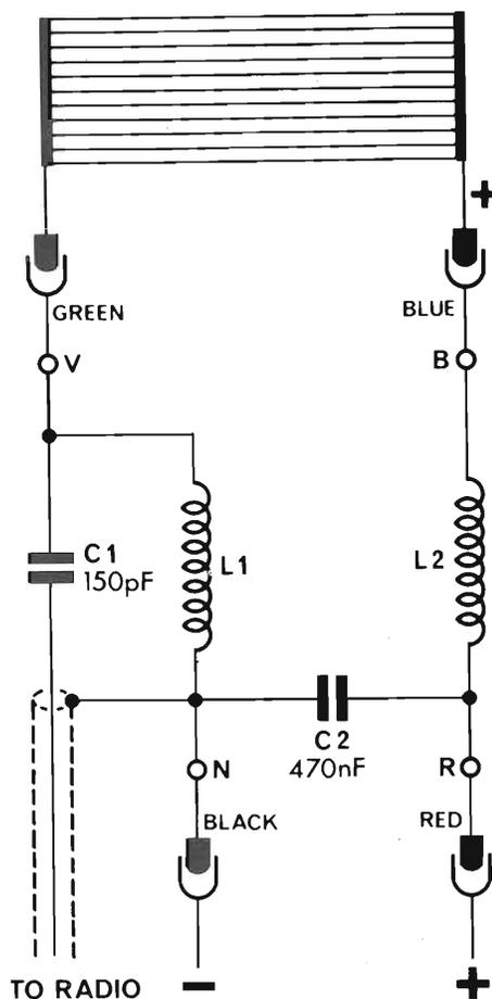
Fig. 1 - Schema elettrico d'antenna a lunotto termico UK237.
