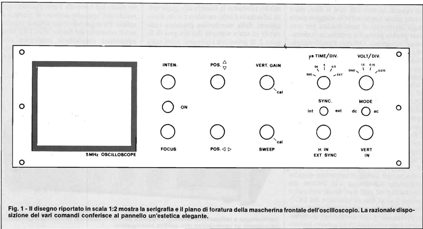
Fig. 1 - Il disegno riportato in scala 1:2 mostra la serigrafia e il piano di foratura della mascherina frontale dell'oscilloscopio. La razionale disposizione dei vari comandi conferisce al pannello un'estetica elegante.
