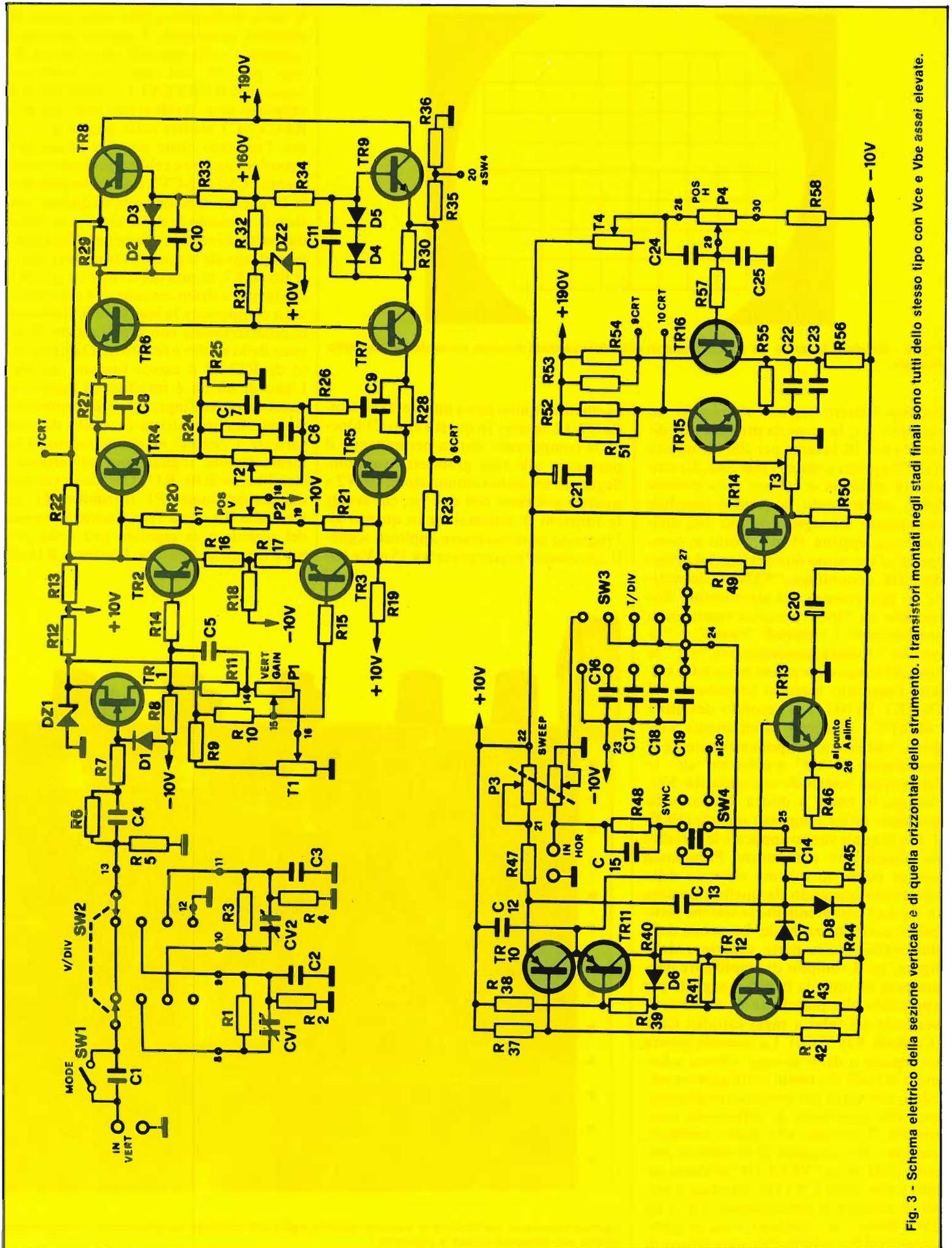
Fig. 3 - Schema elettrico della sezione verticale e di quella orizzontale dello strumento. I transistori montati negli stadi finali sono tutti dello stesso tipo con Vce e Vbe assai elevate.
