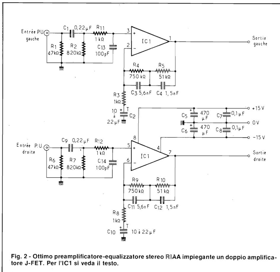
Fig. 2 - Ottimo preamplificatore-equalizzatore stereo RIAA impiegante un doppio amplificatore J-FET. Per l'IC1 si veda il testo.
