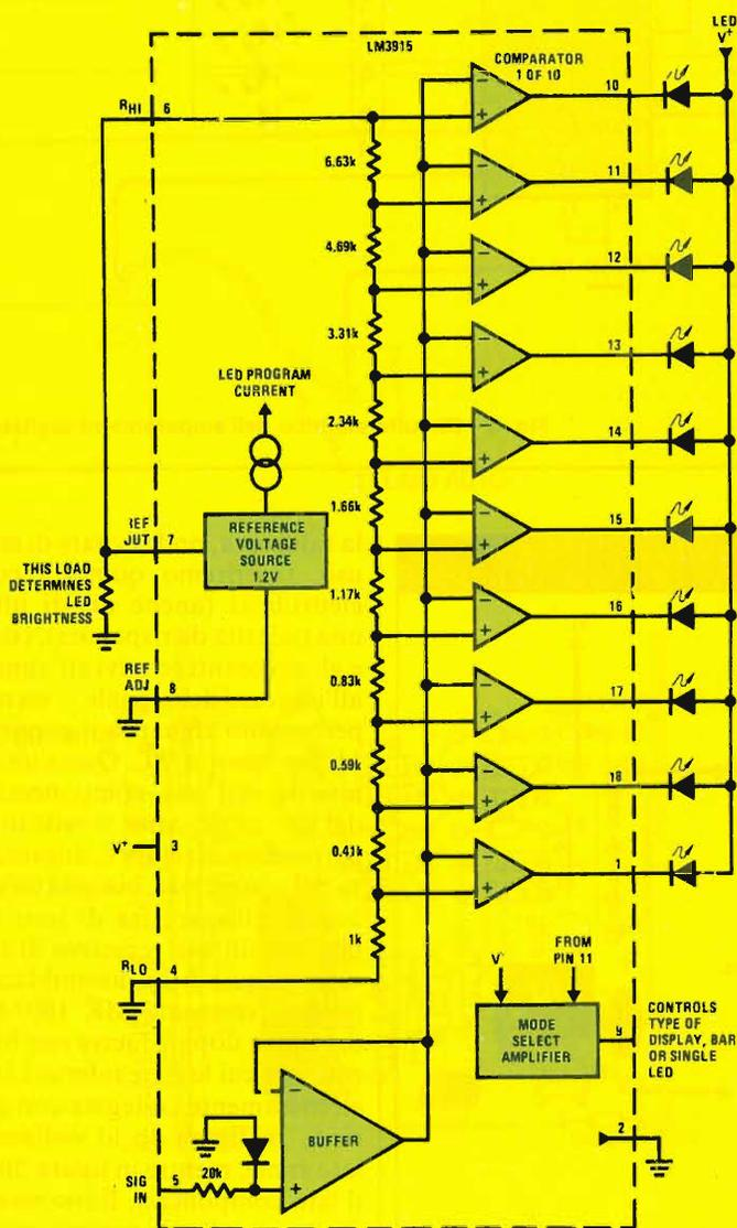
Fig. 2 - Zoccolatura vista dall'alto e relativo circuito interno e blocchi dell'integrato LM 3914.
