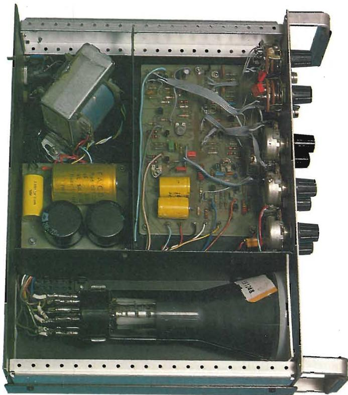
Interno dello strumento a realizzazione ultimata. Si notino i due schermi in ferro che separano le sezioni principali.
