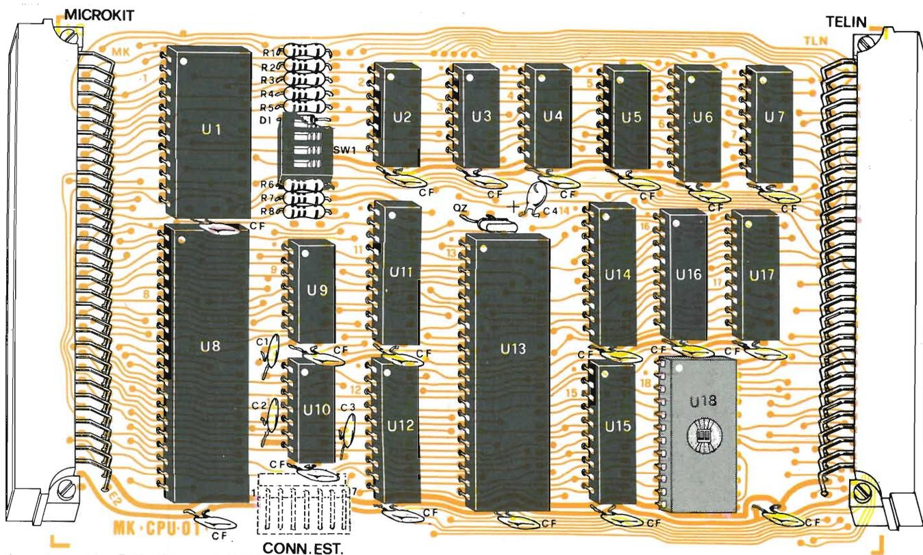
Fig. 7 - Schema di montaggio della scheda MK - CPU 01.
