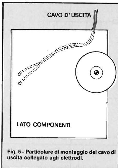
Fig. 5 - Particolare di montaggio del cavo di uscita collegato agli elettrodi.
