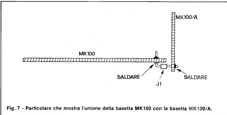
Fig. 7 - Particolare che mostra l'unione della basetta MK100 con la basetta MK100/A.
