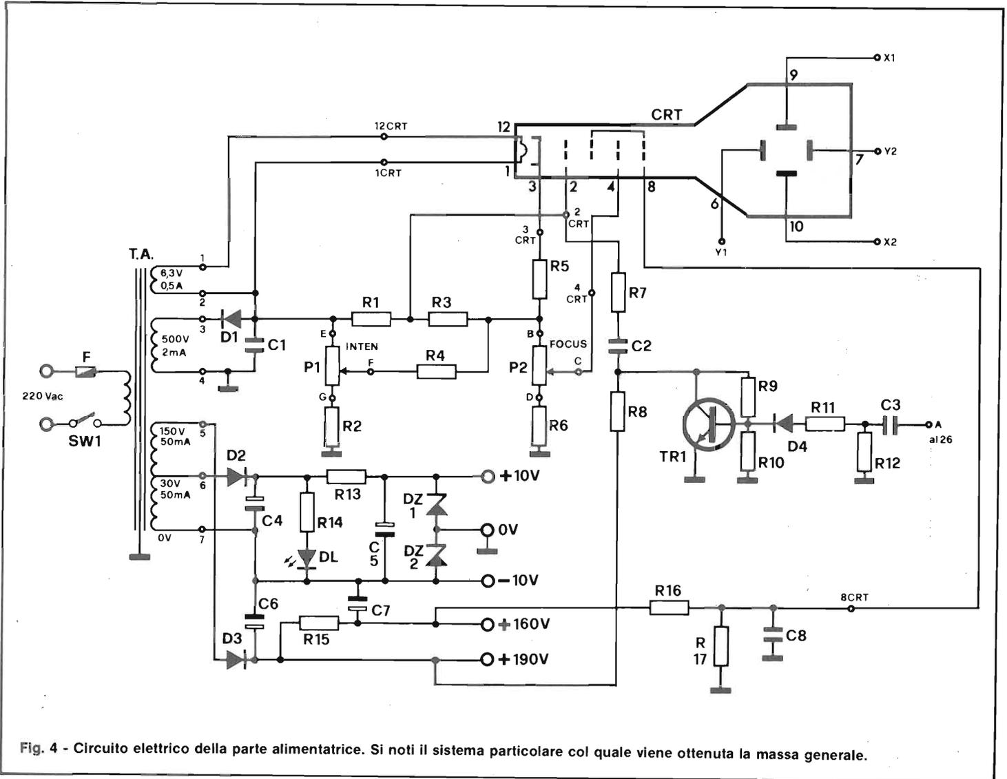
Fig. 4 - Circuito elettrico della parte alimentatrice. Si noti il sistema particolare col quale viene ottenuta la massa generale.
