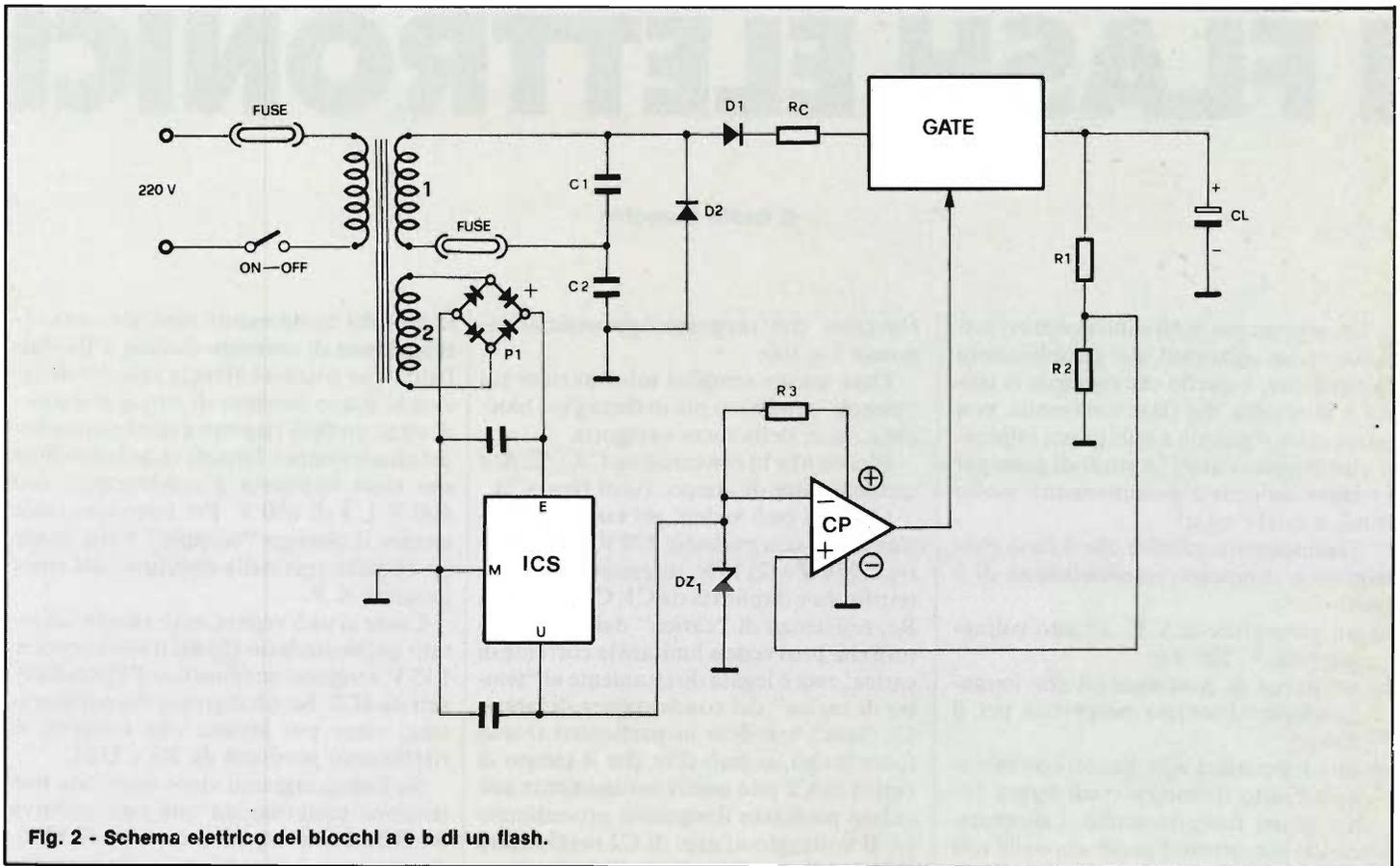
Fig. 2 - Schema elettrico del blocco a e b di un flash.
