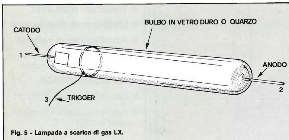
Fig. 5 - Lampada a scarica di gas LX.
