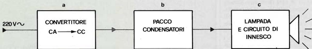
Fig. 1 - Schema a blocchi di un flash elettronico.
