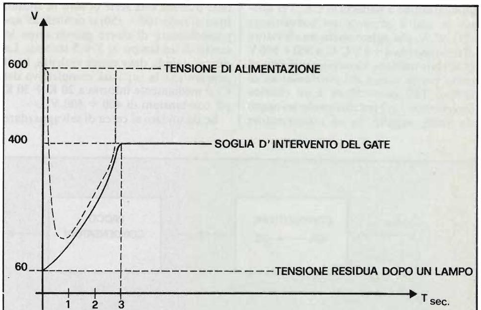
Fig. 3 - Andamento grafico della carica del condensatore.
