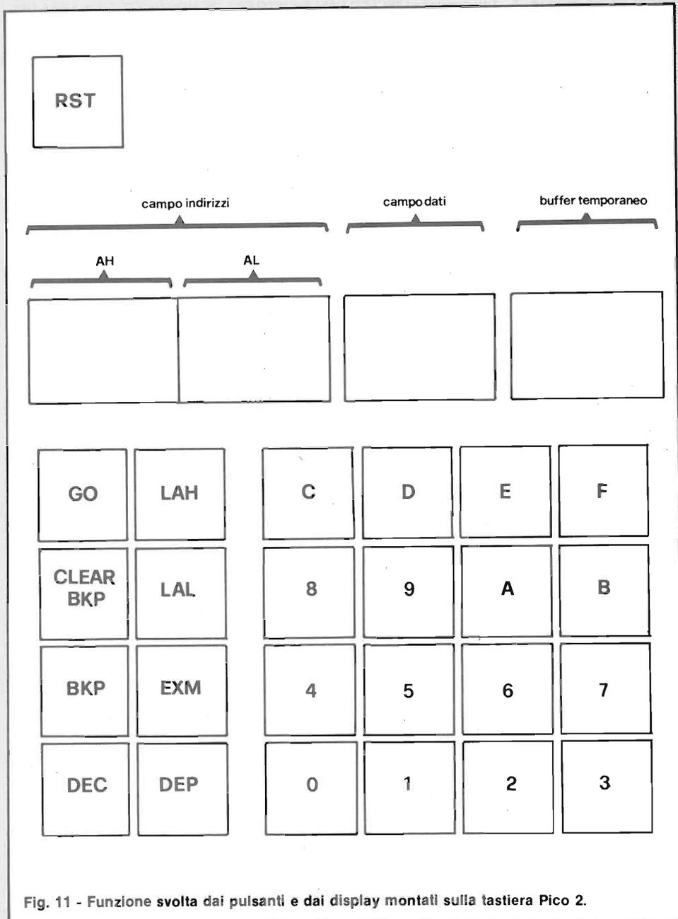
Fig. 11 - Funzione svolta dai pulsanti e dai display montati sulla tastiera Pico 2.
