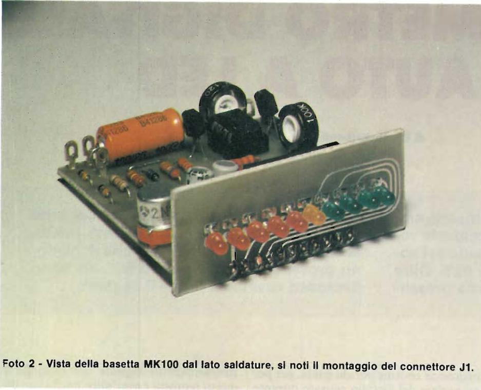
Foto 2 - Vista della basetta MK100 dal lato saldature, si noti il montaggio del connettore J1.
