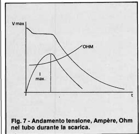
Fig. 7 - Andamento tensione, Ampère, Ohm nel tubo durante la scarica.
