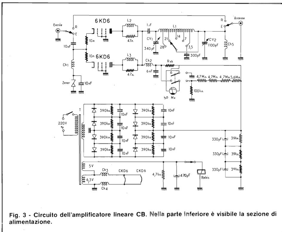
Fig. 3 - Circuito dell'amplificatore lineare CB. Nella parte inferiore è visibile la sezione di alimentazione.
